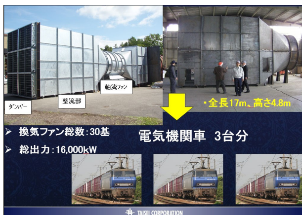
図-18 トンネル換気ファン
