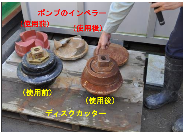
写真-3 ディスクカッターとポンプのインペラー
