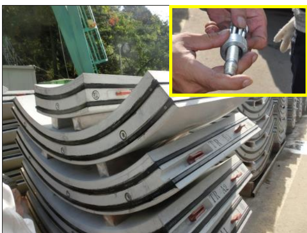
写真-8 セグメントと新型ワンタッチ式継手(右上)
