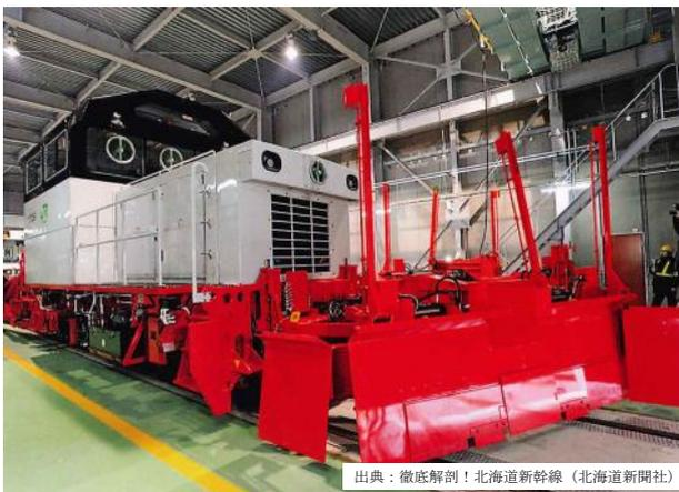
写真-5 三線軌条用の除雪車
