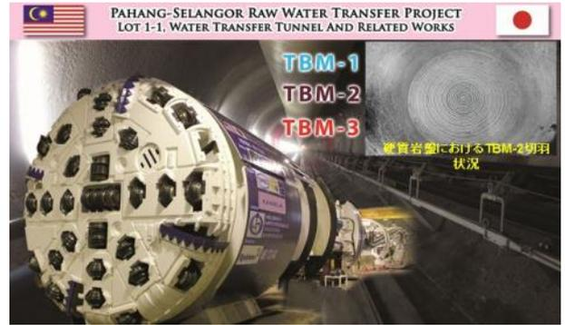
写真-2 カッタ数35個のTBM
