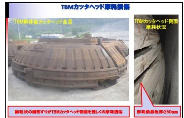
写真-6 掘削で摩耗したカッタヘッド側面
