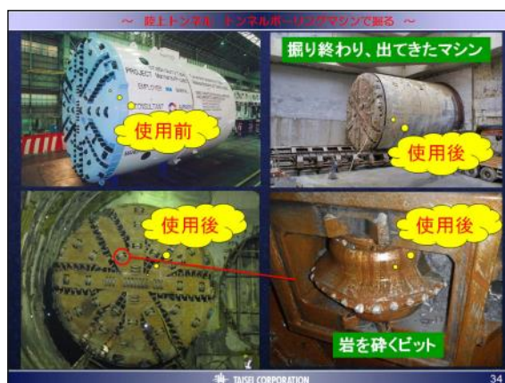
図-18 陸上トンネルを掘削したマシン
