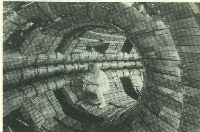
トカマク型装置「JT60」の真空容器内部
