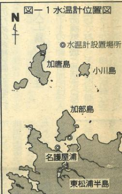
温や塩分が急変する)が当海域で確認されたのである。潮汐と急潮現象は、湾内の海水交換に影響を与える二大要素であり、この海域で急潮現象が頻繁に発生していることは、外洋との海水交換がよくなされていることを意味する。今回の水温調査は、この急潮現象の実態把握が主目的である。観測場所は、湾内・湾入口・外海の合計五カ所(図一参照)。RMT水温計を五カ所の深さに設置して三分ごとに海水温度を測定する。水温計は約三分のデータの記憶できるの計を三カ月に一度の割合で水温計を引き上げ、内部の測定データを取り出す必要がある。事業団では、これまで六度の引き上
