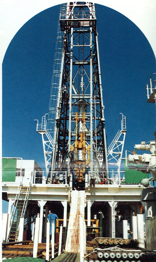
海洋ボーリング 86年5月、対馬西沖合の水深約150mの海域で、海洋ボーリングが行われた。
