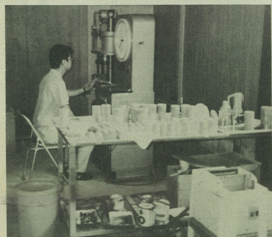
圧縮試験機を購入し、コアの力学試験も可能に
