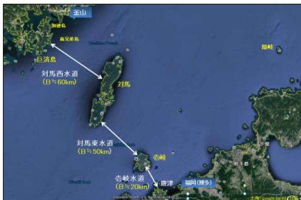
図-4 日韓トンネルの各海峡の幅
